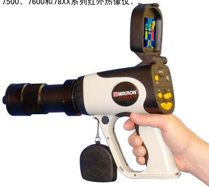
使用鱼眼镜头检测燃烧孔及炉壁
